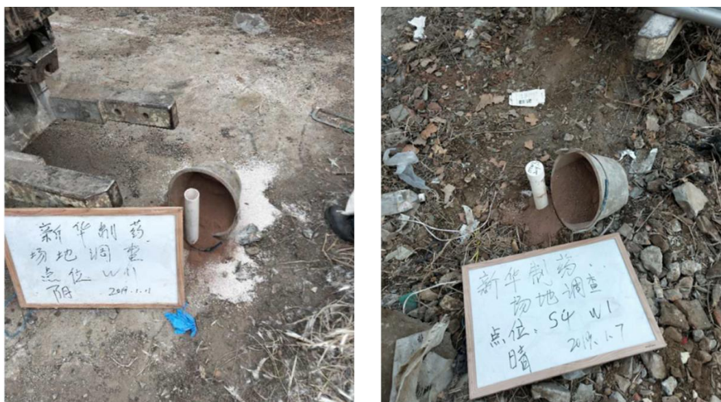
图 3.3-8 本场地所建地下水监测井
